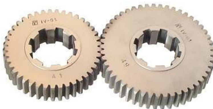
Pignons vitesses de broche, avances et rapports de taraudage
